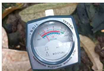
Hình 13. pH đất 4.2 thấp so với yêu cầu kỹ thuật.
